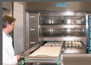
► Inserimento del telaio nella camera Inserting the loader into the chamber
