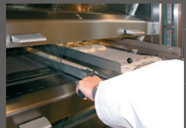
► Estrazione del telaio per infornamento Removing the loader to load the oven
