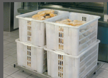
▶ Spostamento delle ceste tramite carrello Inserting the loader into the chamber
