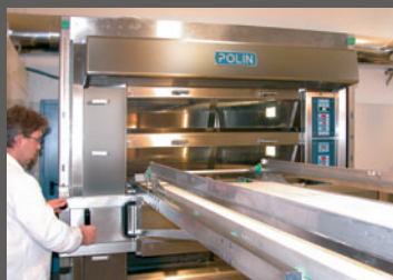
► Posizionamento dell'infornatore Positioning the oven loader
