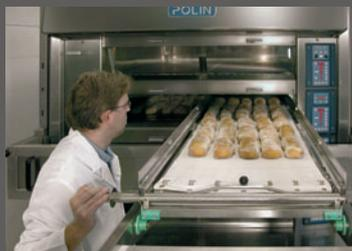
▶ Estrazione del telaio per sfornamento
